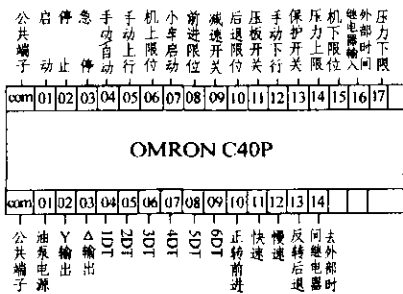
图 1 PLC 输入输出点分配
