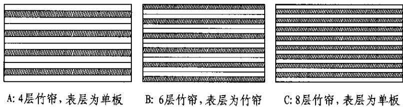
图 1 竹木复合 LVL 的组坯方式
