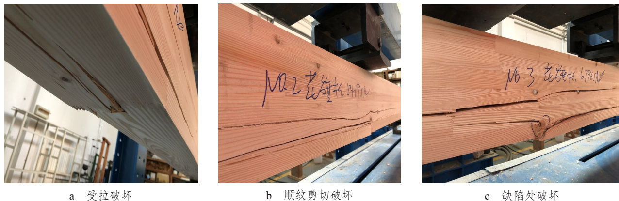
图2 GLT抗弯承载的典型破坏模式
