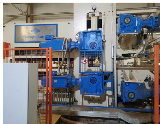
图2 薄板生产用辊式预压机
