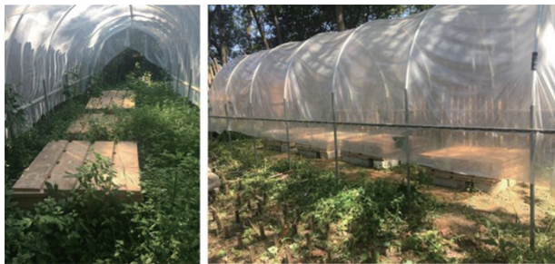
图1 氟虫腈胶合板户外地上暴露试验现场 (广东省林业科学研究院野外试验场,广东广州)
