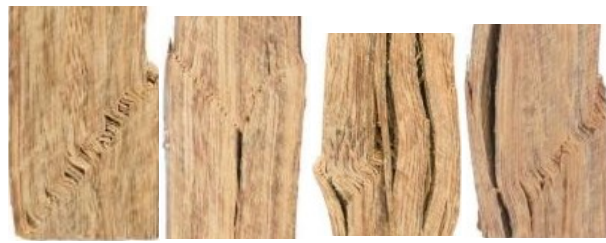
I 皱褶破坏 II Y型裂缝 III 劈裂破坏 IV 混合破坏 a 试件的破坏模式
