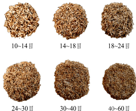
图1 6种形态的玉米秸秆刨花
